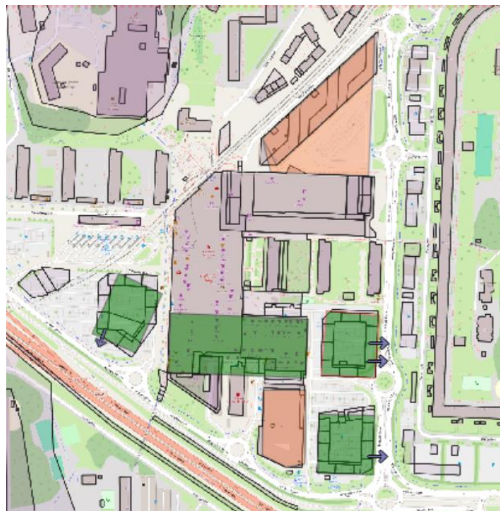
Figur 9. Ventilationspunkter (gråa pilar) samt areakällor (orangea skikt) som ansatts för respektive p-hus och garage i modellen.
